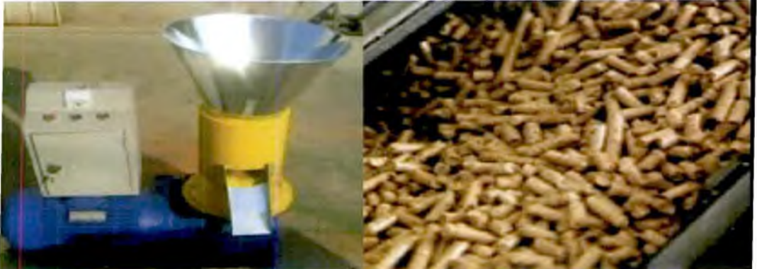
ምስል 4. የሰብል ተረፈ ምርት መኖን ወደ ፔሌት መቀየር ማሽንና ወደ ፔሌት የተቀየረ የሰብል ተረፈ ምርት መኖ
