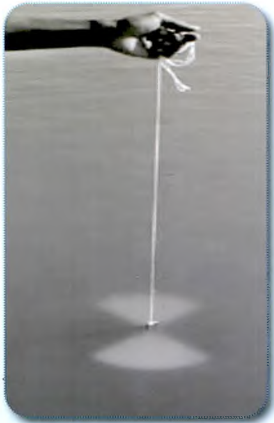
ስዕል 25፡ ሀ/ሴኪ ዲስክ፣ ለ/የውሃን ጥራት በጠፍጣፋ ብረት (ሴኪ ዲስክ) የመለካት ዘዴ እና ሐ/የውሃ ጥራት በእጅ መዳፍ የመለካት ዘዴ
